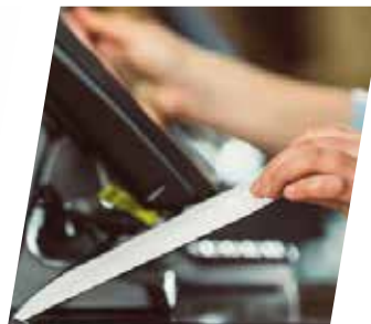
Autocortador de 1.5 millones de cortes
